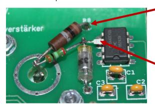
Bohrung zu klein, entweder stumpf Auflöten oder dünnen Draht verwenden
