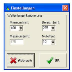
Die Einstellung wird erleichtert, wenn man die Spektrallinien des Quecksilbers (Hg) in das Spektrum einblendet. und die Werte für "Minimum" und "Bereich" solange verändert, bis die eingeblendeten Spektrallinien zu den Peaks im Spektrum passen. Dabei sind Abweichungen im Bereich von 5nm normal.
