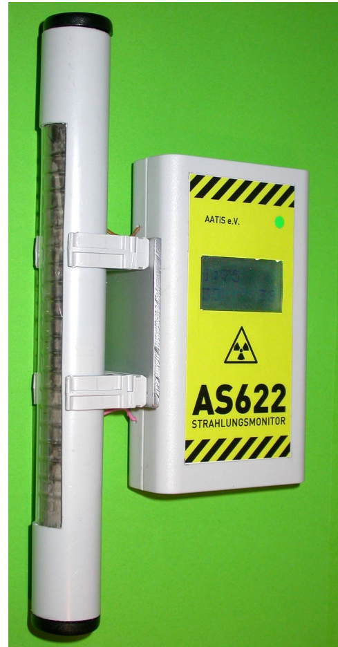
Abb. 5: AATiS-Geigerzähler mit Erweiterungssatz
