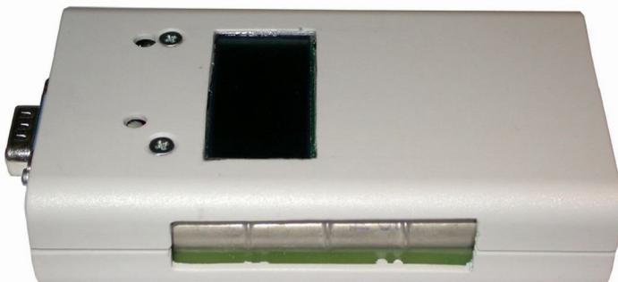
Dieser kann zum Schutz gegen Verschmutzung von innen mit einer dünnen Plastikfolie oder einem grobmaschigen Gitter abgedeckt werden. Je weniger Gehäusematerial sich vor dem Zählrohr befindet, umso empfindlicher ist der Geigerzähler. Der Ausschnitt darf aber auch nicht zu breit gemacht werden, damit die beiden Gehäuseschalen noch sicher ineinander rasten.
