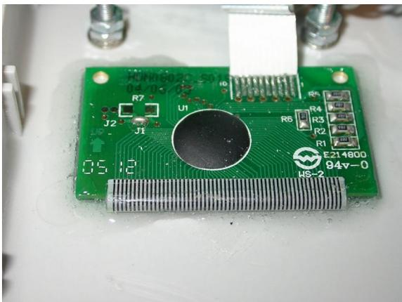
Das Display ist nicht ganz einfach zu montieren, da es nur an der Anschlussseite eine kleine Auflage bietet. Es hat sich bewährt, das Display in der gewünschten Position mit Klebeband zu fixieren und anschließend mit dem Gehäusedeckel zu verkleben (siehe nebenstehendes Foto). Dabei sollte das Display plan mit dem Gehäuse abschließen, damit man später eine passend gestaltete Folie aufkleben kann.
