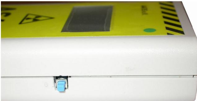
Die Gehäusebearbeitung beginnt mit dem Feilen des Ausschnitts für den Einschalter. Dieser steht seitlich etwas aus dem Gehäuse heraus. Um die Position für den Ausschnitt festzulegen, wird die bestückte Leiterkarte in die untere Gehäuseschale eingelegt. Danach wird die Position des Schalters markiert und mit einer Vierkant-Schlüsselfeile der Ausschnitt eingebracht.
