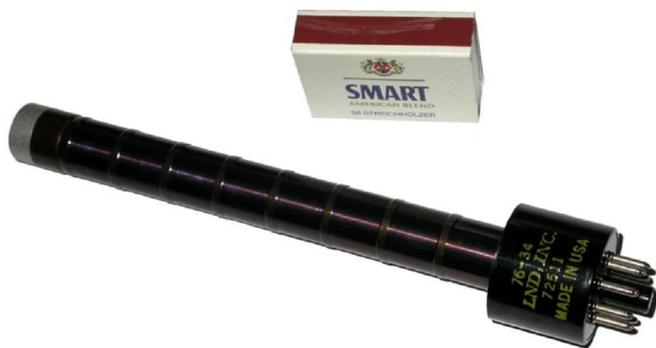
Die Wandstärke des Metallmantels beträgt lediglich  $76\mu\text{m}$ . Dennoch ist das Zählrohr aufgrund mehrerer Versteifungen hinreichend stabil, sollte jedoch sehr vorsichtig gehandhabt werden.
