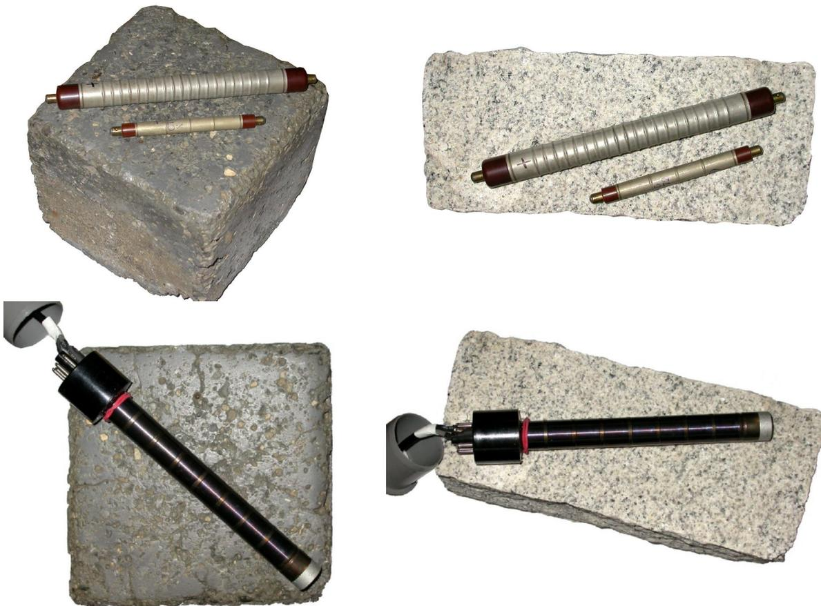
Die Messergebnisse zeigen die deutlich erhöhte Empfindlichkeit des STS-6/SBM-19 und des LND72511 gegenüber dem Standardzählrohr STS-5/SBM-20. Die  $\beta$ -Empfindlichkeit hat sich mehr als verdreifacht, während sich die  $\gamma$ -Empfindlichkeit in etwa verdoppelt hat.
