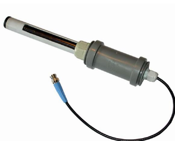
Als Schutzrohr wird ein 25mm PVC-Rohr mit möglichst geringer Wandstärke verwendet. Die Abbildungen zeigen den rechteckigen, mit Folie hinterlegten Ausschnitt im Rohr. Eine Doppelrohrmuffe DN40 dient als „Griffstück“ und schützt gleichzeitig den Sockel des Zählrohrs. Es kann auch eine Doppelrohrmuffe DN50 verwendet werden. Sie liegt besser in der Hand und man hat mehr Freiraum zur Befestigung des PVC-Rohrs.
